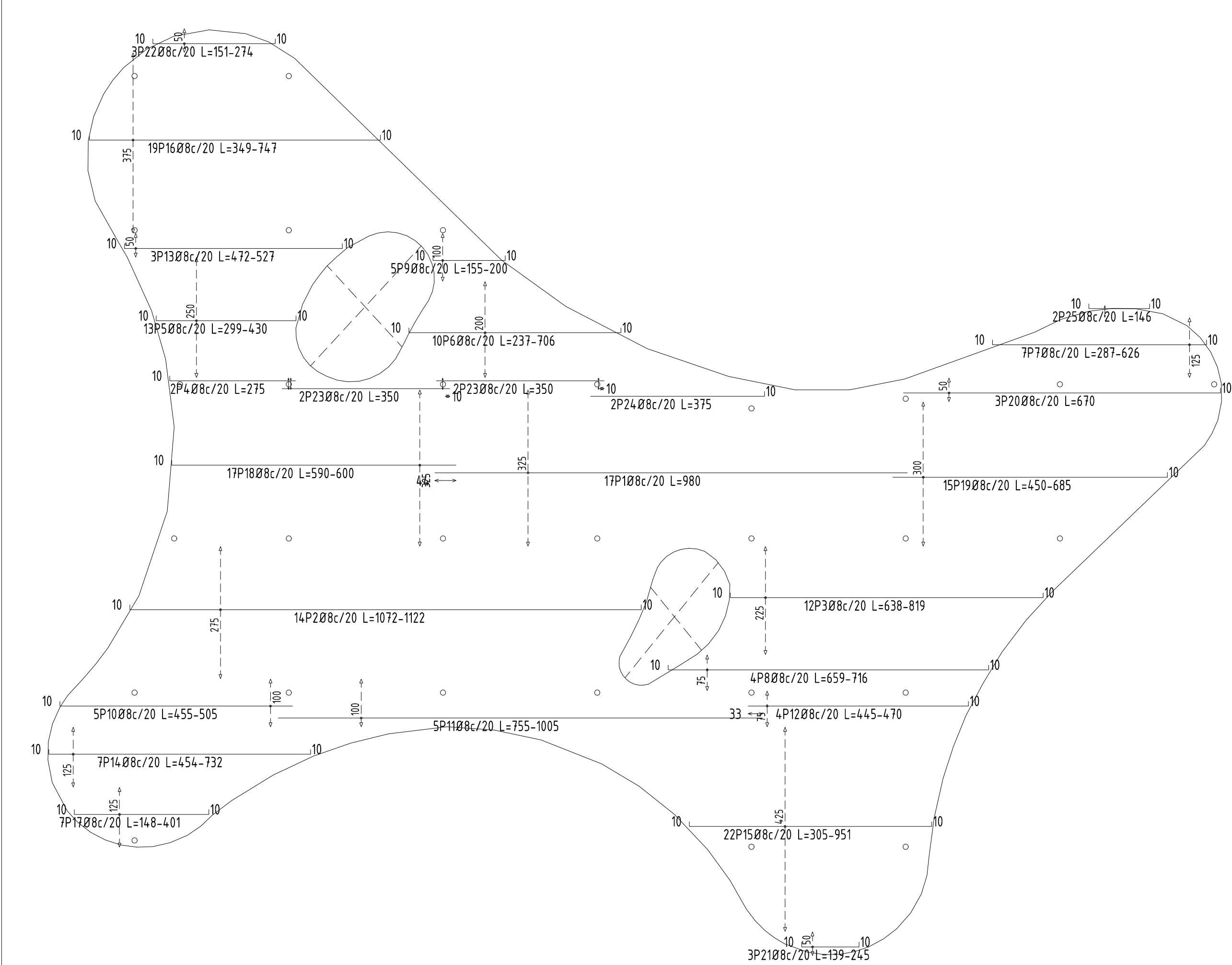
1/75 LOSA SPB ARMADO INFERIOR X
